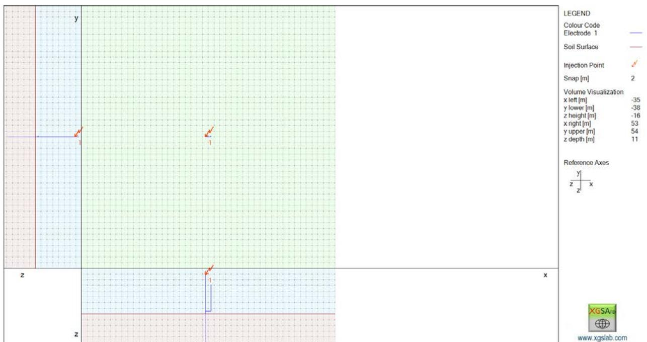
Bild 5-4 2-D-Ansicht der Anordnung entsprechend dem Hintergrund der Berechnung nach IEC 62305-3 mit  $M' = 1,2 \mu\text{H/m}$  bei einem Abstand von 2 m zwischen Ableitung und Näherung. Durchmesser der Ableitung und der Näherung: 10mm Kupfer. Länge der Näherung : 9,25m. Die Näherung endet in einer Höhe von 10,25m.
