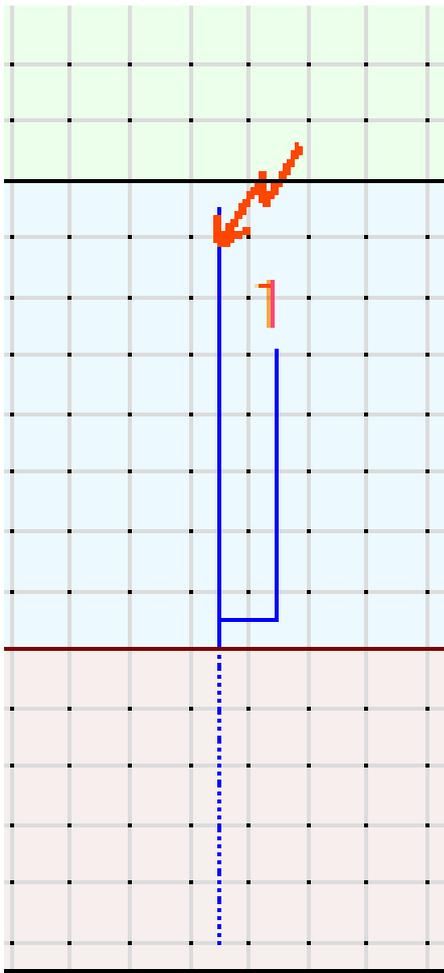
Bild 5-3 Detailansicht der Anordnung entsprechend dem Hintergrund der Berechnung nach IEC 62305-3 mit  $M' = 1,2 \mu\text{H/m}$  bei einem Abstand von 2 m zwischen Ableitung und Näherung. Durchmesser der Ableitung und der Näherung: 10mm Kupfer. Länge der Näherung : 9,25m in Luft.
