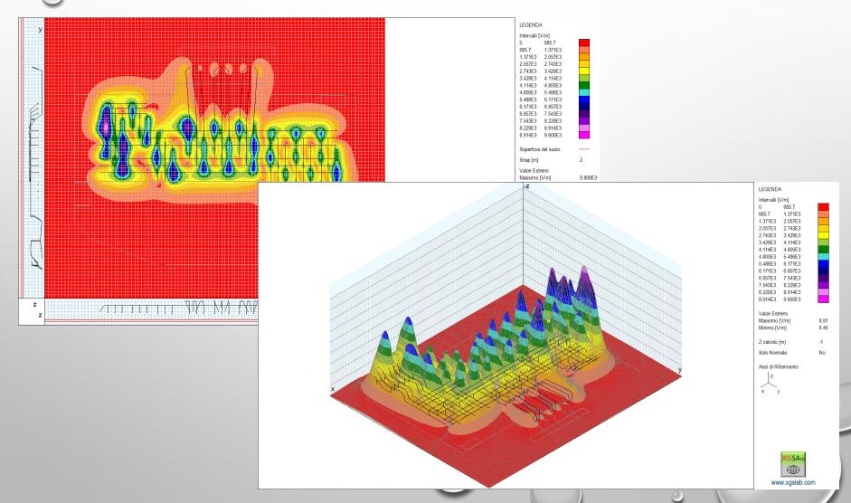
UNDERGROUND POWER STATION: PIPE FLOW TYPE, No 4 POWER UNITS SINGLE PHASE TO EARTH FAULT CURRENT 300 A
